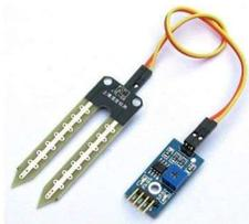
Este sensor es similar al sensor de temperatura, pero mide la humedad. Algunos de estos sensores son en forma de varillas y se pueden colocar en el suelo para medir su humedad. A partir de esta información y si la humedad es baja, un sistema de riego puede ser activado automáticamente o un mensaje puede ser enviado al celular del responsable.
